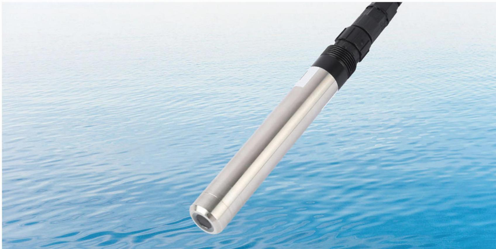
禹山ODO系列荧光法溶解氧传感器，专为养殖市场量身定制，采用禹山自主研发的荧光材料。不消耗氧，无流速限制，无需电解液，免于维护和校准，抗干扰能力强，具有出色的稳定性。内置温度传感器，自动温度补偿。数字式RS485输出，集成应用更方便。
